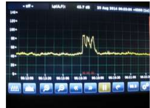
Feueralarm mit drei Sirenen-Signalen
